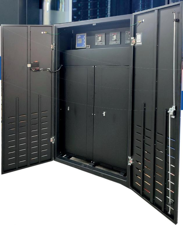
Se fabrican bajo el requerimiento del cliente, en capacidades de 20 a 300 KVA y pueden incluir o no, transformador de aislamiento tipo K4, K13 o K20, para acoplamiento de voltaje o simple aislamiento magnético. Así mismo pueden incluir monitor de energía y supresor de transientes.
